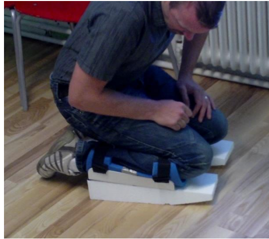
Figur 26. Funktionsmodell - Version D1. Fast vinkel mellan knädel och skenbensdel. Bakåtlutad.
