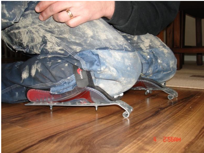
Figur 15. Funktionsmodell – Version 1. Knäet hänger i luften. All belastning på skenbenet.
