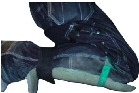
Figur 16. Funktionsmodell – Version 2. Knäet hänger i luften. Knäplatta ger god sidostabilitet. Vristklack.
