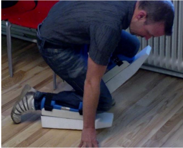
Figur 26. Funktionsmodell - Version D1. Fast vinkel mellan knädel och skenbensdel. Bakåtlutad.
