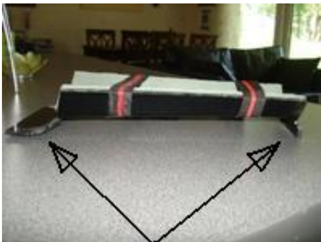
Figur 16. Funktionsmodell – Version 2. Knäet hänger i luften. Knäplatta ger god sidostabilitet. Vristklack.
