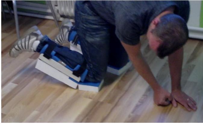
Figur 29. Funktionsmodell – Version D2. Flexibel vinkel mellan knädel och skenbensdel. Framåtlutad.
